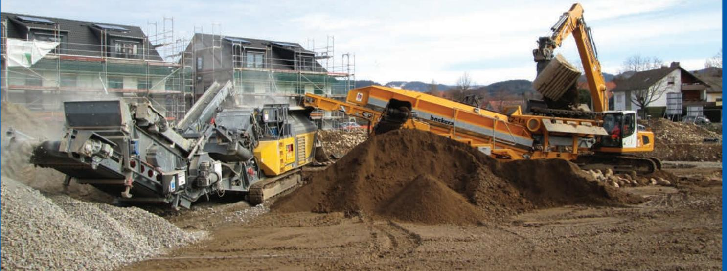
Im Bereich Mineral setzt die Firma Backers auf das Konzept - erst sieben, dann brechen. Zunächst wird der (Lehm-)Boden mit einer Körnung von ca. 22-25mm gesiebt. Der Feinanteil verbleibt direkt auf der Baustellung kann dort wiederverwendet werden. Der Stenanteil (>22-25mm) wird bei dem Siebvorgang gereinigt und kann so direkt in den Bunker des nachfolgenden Prallbrechers übergeben werden. Die dort gebrochenen Steine können als Frostschticht genutzt werden.
